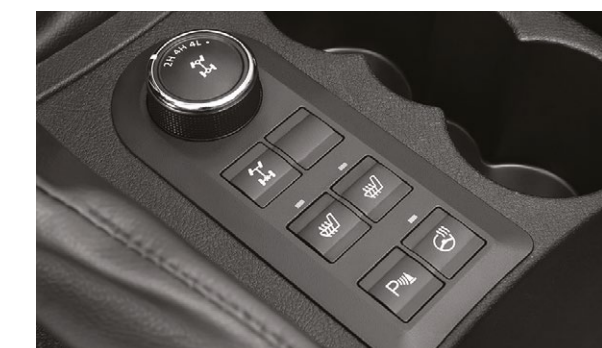
Unidad de control de sistemas en la consola central
