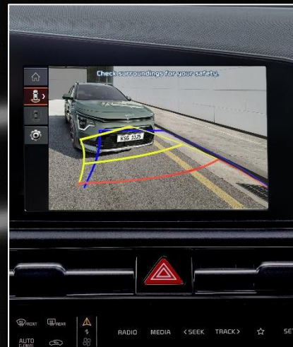
Cámara de retroceso con líneas adaptativas
